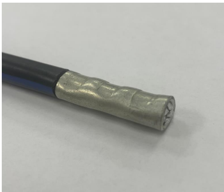
Рисунок 21 - Пример обжатия многожильного провода
